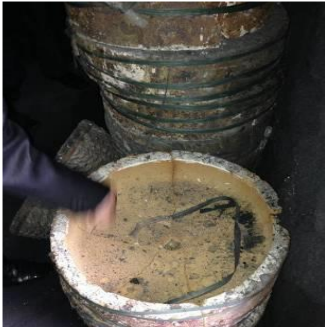
Hộp bao nung để chứa sản phẩm gôm bên trong
